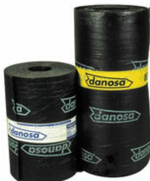
Lámina impermeabilizante bituminosa de superficie no protegida tipo LBM (SBS)-48-FP. Compuesta por una armadura de fieltro de poliéster reforzado, recubierta por ambas caras con un mástico de betún modificado con elastómeros (SBS), usando como material antiadherente un film plástico por ambas caras.
