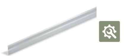
Son perfiles de chapa galvanizada, utilizados como remate de la impermeabilización en petos y paramentos verticales, evitando así el desprendimiento de la lámina del soporte. Se rematan con ELASTYDAN PU 40 Gris o un cordón de silicona, para evitar la entrada de agua entre el soporte y la lámina.La fijación del perfil metálico al paramento vertical puede variar en función de las caracteristicas del soporte.
