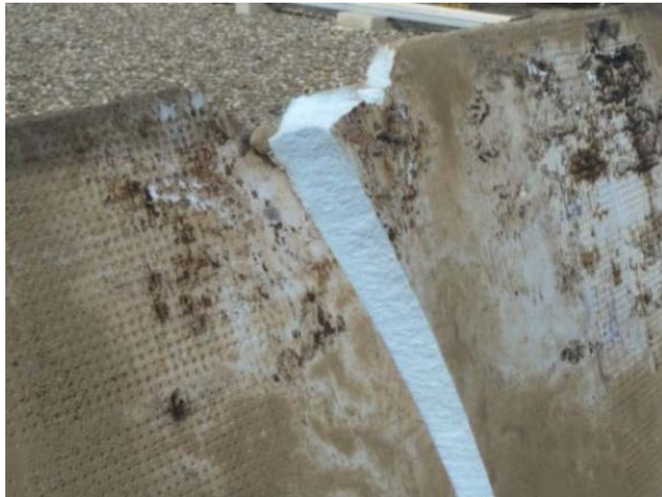
Estado de conservación del interior de planchas de XPS transcurridos 31 años en cubierta plana invertida. Informe CSIC, 2011.
