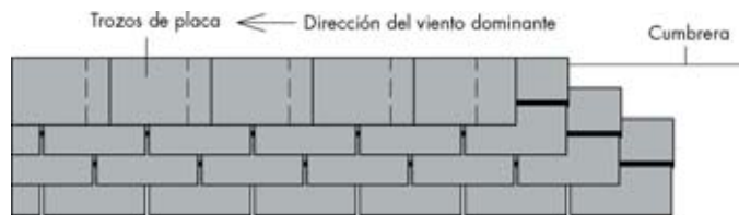
Figura 9. Colocación de las placas de la cumbrera.
