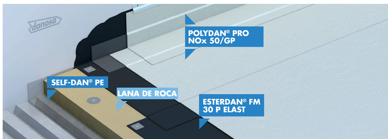
CUBIERTA DECK BICAPA
