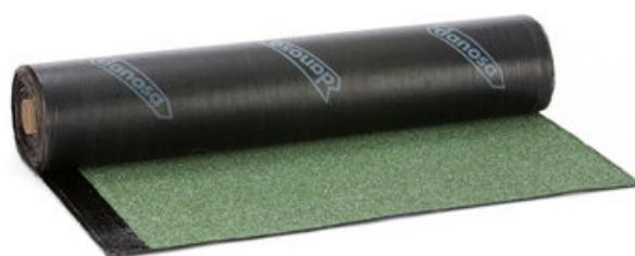
Lámina bituminosa de superficie autoprotegida tipo LBM(SBS)-50/G-FP con tratamiento anti-raíz. Compuesta por una armadura de fieltro de poliéster reforzado, recubierta por ambas caras con un mástico de betún modificado con elastómeros, acabada en su cara externa en gránulos de pizarra de color verde, como material de protección. En su cara interna, como material antiadherente, incorpora un film plástico de terminación.
