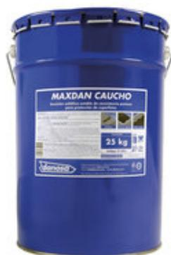
MAXDAN CAUCHO es una emulsión bituminosa de consistencia viscosa y de aplicación en frío. Compuesto por la dispersión de pequeñas partículas de betún con un agente emulsionante de carácter aniónico y modificada con una emulsión de latex. Clasificado según norma 104231-99 como EB (Emulsión tipo B) de rotura lenta.
