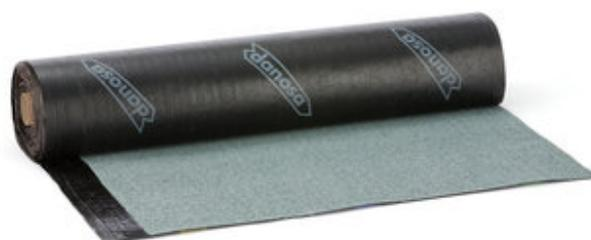
Lámina bituminosa de superficie autoprotegida tipo LBM(SBS)-56/G-FP R. Está compuesta por una armadura de fieltro de poliéster reforzado y estabilizado de gran gramaje, recubierta por ambas caras con un mástico de betún modificado con elastómeros (SBS), acabada en su cara externa en gránulos de pizarra de color gris (claro), como material de protección. En su cara interna, como material antiadherente, incorpora un film plástico de terminación.
