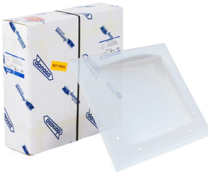
Elemento superior que se instala bajo la cúpula para crear una cámara intermedia y evitar condensaciones. Se fabrica por termoconformado a partir de una plancha de metacrilato de 3 mm de espesor.
