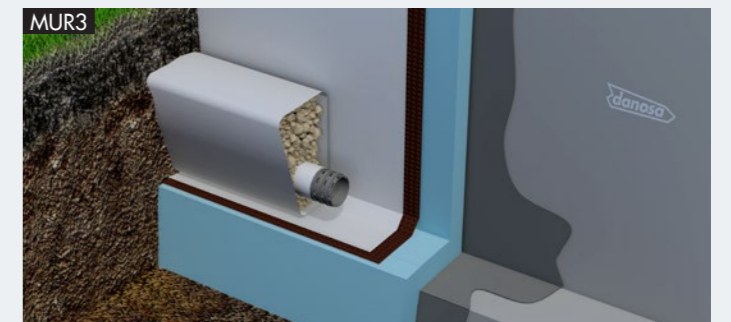
Rehabilitación energética estructuras enterradas. Sistema MUR3. Productos: DANOPREN TR + DANOCRET PROTECT FLEX
