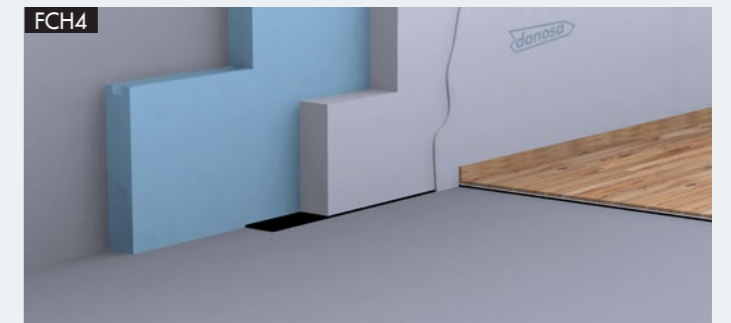
Rehabilitación energética de paredes mediante aislamiento en cámara. Sistema FCH4. Productos: DANOPREN PR
