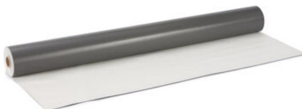
DANOPOL HS 1.8 est une membrane synthétique à base de PVC plastifié blanc, fabriquée moyennant un procédé de calandrage et renforcée avec une armature en maille de fibre polyester. Cette membrane est résistante aux intempéries et aux rayons ultra-violets.
