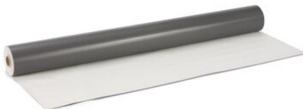
DANOPOL HS 1.5 est une membrane synthétique à base de PVC plastifié, fabriquée moyennant un procédé de calandrage et renforcée avec une armature en maille de fibre polyester. Cette membrane est résistante aux intempéries et aux rayons ultra-violet.
