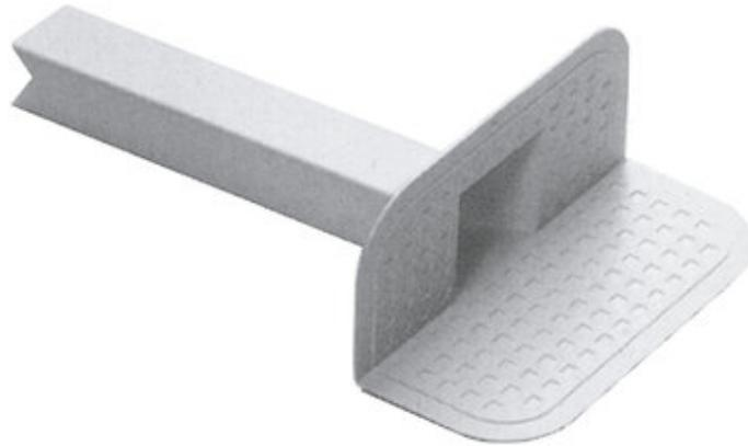
Cazoleta mixta para balcones de TPE en color blanco y sección exterior 50 x 45 mm, compatible con todas las membranas bituminosas, mediante soldadura por calor. Perfectamente resistente a la llama, la corrosión y la intemperie, es dúctil y fácilmente manejable. De una sola pieza, la cazoleta cuenta con una base soporte con relieve, para facilitar la penetración del betún. El manguetón está rematado en pico para facilitar el desagüe.
