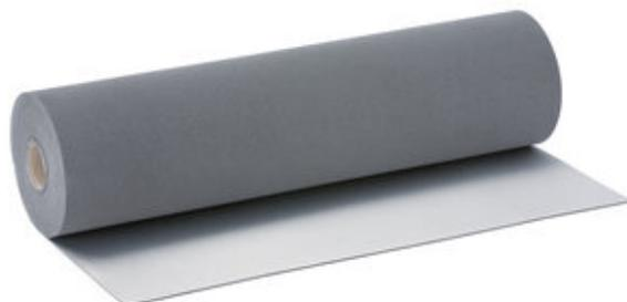
Membrana flexível de polietileno quimicamente reticulado que proporciona ao produto uma estrutura interna elástica. Acabamento na face superior com filme de polietileno aluminizado de LDPE. Acusticamente, o CONFORDAN AL funciona como um amortecedor quando aplicado no sistema massa-mola-massa.
