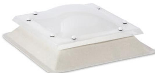
Claraboia fixa com composta de cúpula dupla de metacrilato de 3mm de espessura, fixada sobre uma base de poliéster reforçado de 15cm de altura, para iluminação natural, utilizada em qualquer cobertura e prédio.
