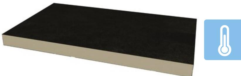
Painéis de isolamento rígidos e leves à base de espuma de poliisocianurato (PIR), de fácil colocação, revestidos em ambas as faces com um complexo multicamada de véu de fibra de vidro e acabamento betuminoso.
