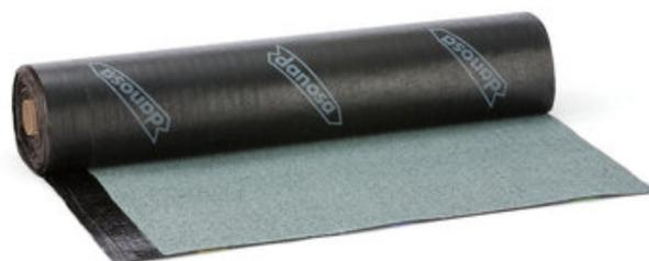
O ESTERDAN PLUS 40/GP ELAST. é uma membrana impermeabilizante betuminosa de superfície auto-protegida de 4.0 kg/m<sup>2</sup>. É composta por uma armadura de feltro de poliéster reforçado, recoberta nas duas faces com um mástico de betume modificado com elastómeros (SBS), usando como material de protecção na face externa da membrana, ardosia. Como material anti-aderente, na face interna usa-se um filme plástico.
