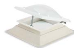
DANOVENT® MANUAL (Ventilação) Clarabóia prática com cúpula e válvula de metacrilato, com armadura de poliéster. Produto para iluminação natural e ventilação, mediante abertura manual por manivela
