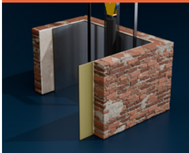
ISOLAMENTO ACÚSTICO EM POÇO DE ELEVADOR
